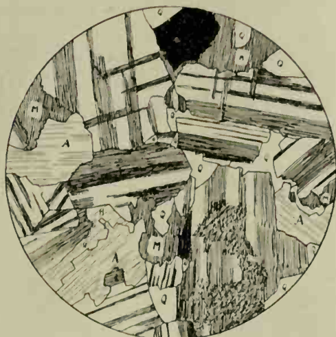
FIG. 16. — Diorite augitique micacée. Coupe n° 2303 pw . Lumière naturelle. Les feldspaths en lumière polarisée. Grossissement = 19 diam. M = biotite; A = pyroxène; Q = quartz. Anorthite mêlée.
