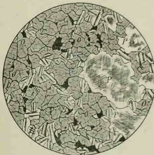
FIG. 21. — Garewaite de Garewata . Coupe 168 Ou. Lumière naturelle. Les feldspaths kaolinisés ont été reconstitués et supposés dessinés en lumière polarisée. P = pyroxène. O = olivine. F = feldspaths. Les grains opaques sont de la chromite.
