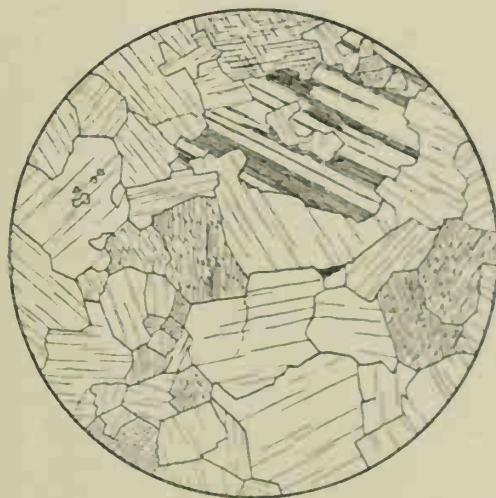
FIG. 7 pw. — Hornblendite. Coupe 5035 pw. Grossissement = 29 diam. Amphibole formant la masse principale, avec grains rares d'anorthite.
