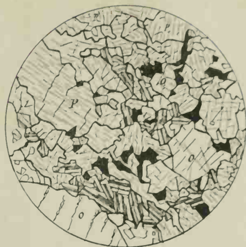
FIG. 12. — Gabbro à olivine mélanocrate. Coupe n° 44 Ou. Lumière naturelle. Grossissement = 22 diam. O = olivine; P = pyroxène. Les feldspaths sont dessinés avec les nicols croisés. La coupe montre la localisation du feldspath dans les cryptes.
