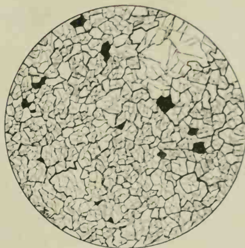
FIG. 18. — Dunite filonienne de Garewaia . — Coupe n° 160 Ou. Grossissement = 13 diam. Lumière naturelle. Octaédres de chromite disposés dans une masse grenue formée par les grains d'olivine, avec cristal développé en apparence porphyriquement.
