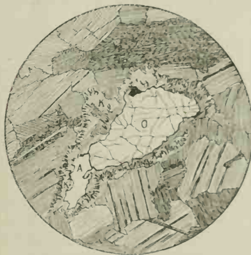
FIG. 8. — Troctolite. Coupe \pm 8 \mu . Grossissement = 48 diam. O = olivine ; K = kéliphite dans une masse formée de grains de feldspaths.
