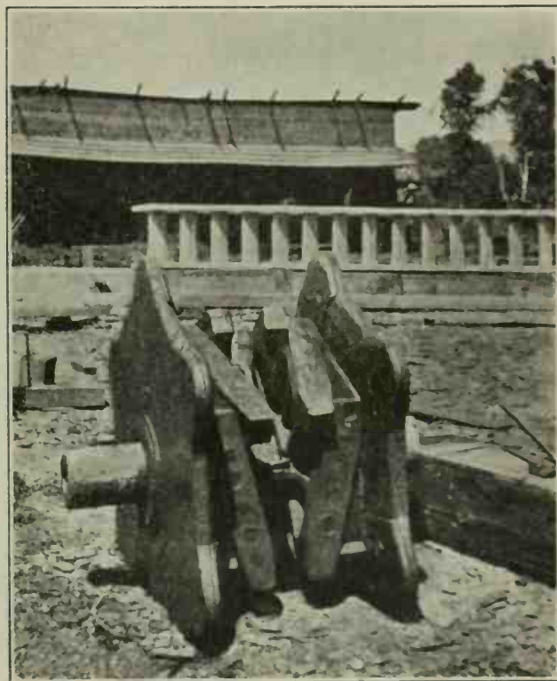
FIG 64 B. — Tambour inférieur d'une drague Ophir.
