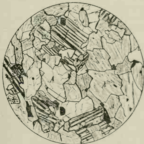
FIG. 22. — Issite à plagioclase. Coupe n° 1036 Ou. Lumière naturelle. Les feldspaths en lumière polarisée. Grossissement = 22 diam. A = amphibole. F = feldspath.
