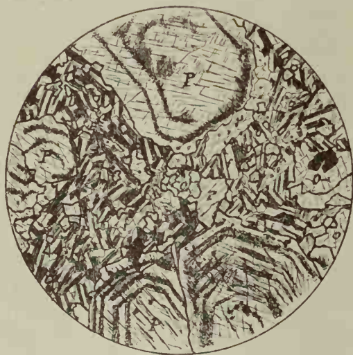
FIG. 26. — Microgabbro . Coupe n° 441 Ou. Lumière naturelle. Les feldspaths en lumière polarisée. Grossissement = 13 diam. P = pyroxène. O = olivine. F = feldspath. Pâte microgrenue.
