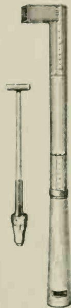
FIG. 45.—Pompe de prospection. Type primitif utilisé dans l'Oural pour épuiser l'eau pendant le creusement des puits.
