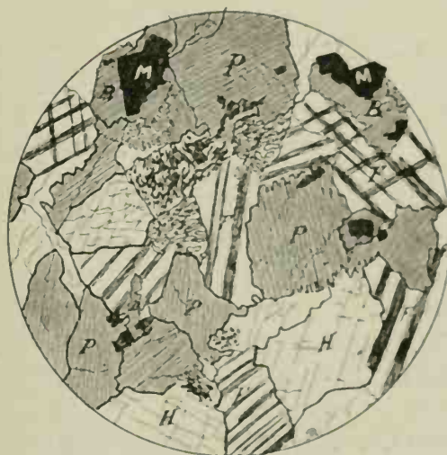
FIG. 15 Ou. — Gabbro-diorite. Coupe n o 1090 Ou. Lumière naturelle. Les feldspaths en lumière polarisée. Grossissement = 22 diam. P = pyroxène; A = amphibole; M = magnétite.
