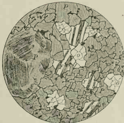
FIG. 10. — Tilaite porphyroïde . Coupe 166 Ou. Grossissement = 13 diam. Les feldspaths en lumière polarisée. M = magnétite; P = pyroxène; O = olivine; F = feldspath.
