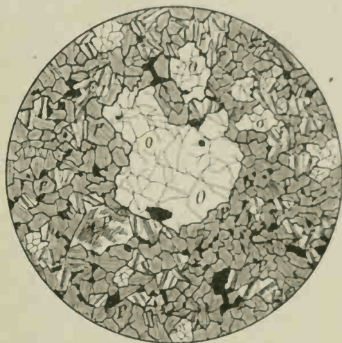
FIG. 25. — Berbachite porphyroïde à olivine . Coupe n° 1142 Ou. Lumière naturelle. Les feldspaths en lumière polarisée. O = olivine. P = pyroxène. F = plagioclase. Magnétite en grains opaques.
