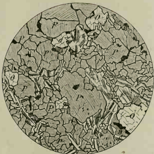
FIG. 9. — Tilaite . Coupe n° 167 Ou. Lumière naturelle. Feldspath en lumière polarisée. Grossissement = 13 diam. M = magnétite; P = pyroxène; O = olivine; F = anorthite. Structure cryptique.
