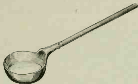
FIG. 48. — Kofscha servant au lavage des sables platinifères.
