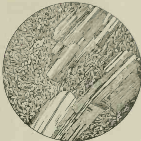
FIG. 27. — Microgabbro. Coupe n° 318. Lumière polarisée. Grossissement = 16 diam. Phénomènes cristallins dans une pâte microcristalline formée d'augite, de magnétite et de plagioclases.
