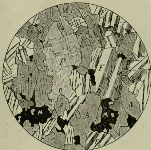
FIG. 14 Ou. — Norite à micropegmatites. Coupe n° 1084 Ou. Lumière naturelle. Les feldspaths en lumière polarisée. Grossissement = 22 diam. P = pyroxène; M = magnétite; B = biotite; H = hypersthène. Micropegmatites d'hypersthène et de feldspath, puis d'hypersthène et de magnétite.
