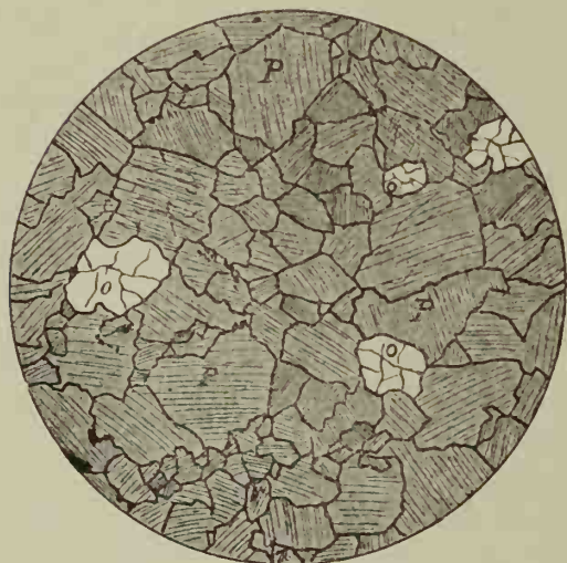
FIG. 6 Ou. — Pyroxénite a olivine . Coupe 1080 Ou. Chambre claire. Lumière naturelle. Grossissement = 13 diam. O = olivine; P = pyroxène.
