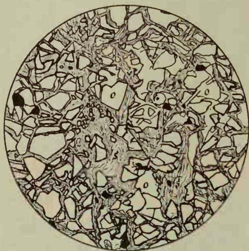
FIG. 3. — Dunite massive serpentinisée . Coupe n° 706 Ou 1 . Lumière naturelle. Grossissement = 22 diam. La coupe montre des noyaux d'olivine disséminés dans la masse serpentineuse due à l'antigorite.
