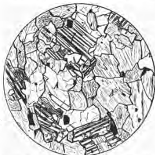
Diorite anorthique filonnienne. Coupe n° 1036. Lumière naturelle. Grossissement = 22 diam. A = amphibole. f = feldspath. Les feldspaths avec nicols croisés.
