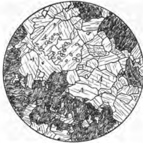
Gabbros ouralitisés. Coupe n° 1048. Lumière naturelle. Chambre claire. Grossissement = 13 diam. A = amphibole. f = feldspath formant la masse kaolinisée. La coupe montre une plage d'amphibole à individus indifféremment orientés, disséminés dans une masse kaolinique.
