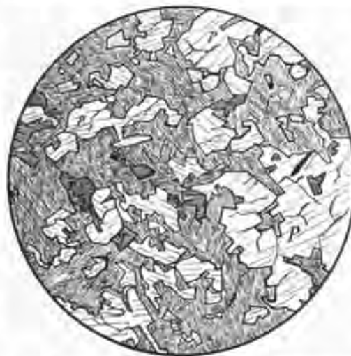
Type doléritique à structure ophitique. Coupe n° 115. Grossissement = 13. T = leucoxène. P = pyroxène. f = feldspath décomposé. La coupe montre les plages d'augite moulant des plagioclases d'habitus microlithique, transformés en kaolin.
