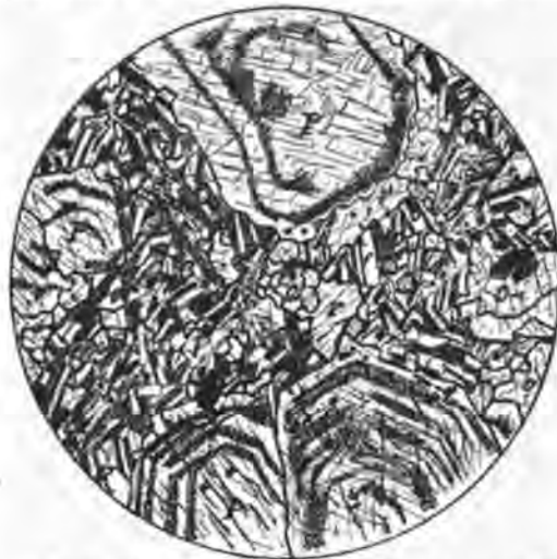
Micro-gabbro. Coupe n° 441. En lumière naturelle. Les feldspaths sont dessinés avec les nicols croisés. Grossissement = 13 diam. P = pyroxène, O = olivine, f = feldspath. La coupe montre la structure micro-grenue et le caractère particulier du pyroxène.
