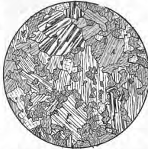
Gabbro ouralitisé à grain fin (facies mélanocrate). Coupe n° 1018. Lumière naturelle. Les feldspaths en lumière polarisée. Grossissement = 13 diam. A = amphibole. P = pyroxène. f = feldspath.
