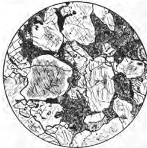
Gabbro à olivine. Coupe n° 122. Lumière naturelle. Grossissement = 22 diam. O = olivine. P = pyroxène. Mica brun. F = masse feldspathique kaolinisée. La coupe montre les éléments ferro magnésiens soudés en plages qui sont disséminés dans une masse feldspathique complètement kaolinisée.
