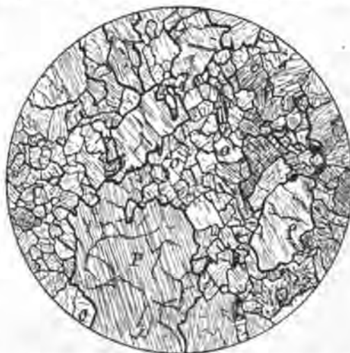
Pyroxénite. Coupe n° 191 b. Chambre claire. Lumière naturelle. Grossissement = 13 diam. O = olivine. P = pyroxène. Le dessin montre les grands cristaux réunis en plages réparties dans une masse grenue.
