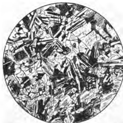
Granulite filonienne à plagioclase. Coupe n° 1032. Chambre claire. Grossissement = 13 diam. Nicols croisés. M = mica. f = feldspath. Q = quartz.
