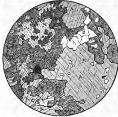
Gabbro ouralitisé à mica. Coupe n° 1015. Lumière naturelle. Chambre claire. Grossissement = 13 diam. A = amphibole. M = mica noir. f = feldspath kaolinisé. Q = quartz. Le dessin montre les plages corrodées de mica et d'amphibole dispersées dans l'élément feldspathique kaolinisé.
