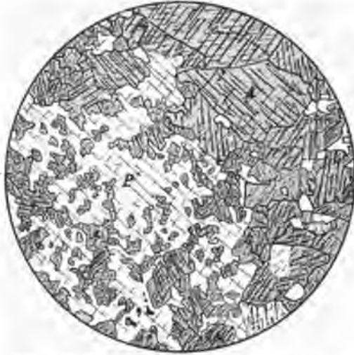
Plages de pyroxène en voie d'ouralitisation. Coupe n° 1051. Chambre claire. Lumière naturelle. Grossissement = 37 diam. P = pyroxène. A = amphibole. La coupe montre des grandes plages de pyroxène complètement ouralitisées, tandis que sur d'autres le pyroxène est encore visible et marbré de taches d'amphibole.
