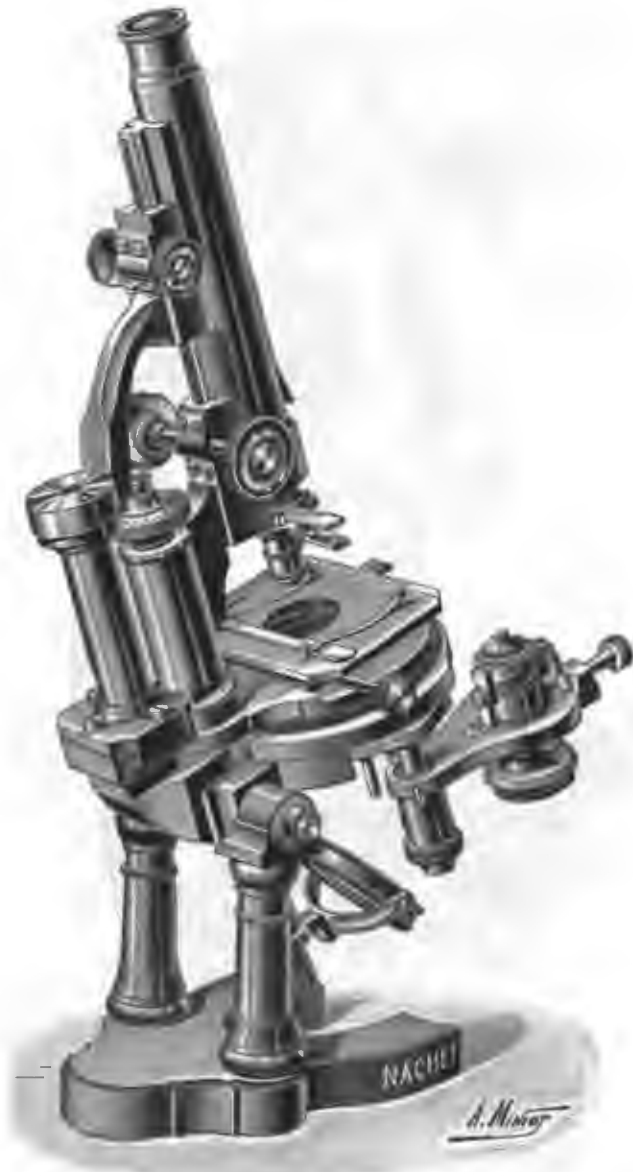
Fig. 206. Microscope polarisant du type n° 2 pour recherches pétrographiques, à centrage permanent. Modèle de la maison NACHER à Paris.
