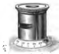
Fig. 200. Nicol auxiliaire se plaçant au dessus de l'oculaire des microscopes polarisants.
