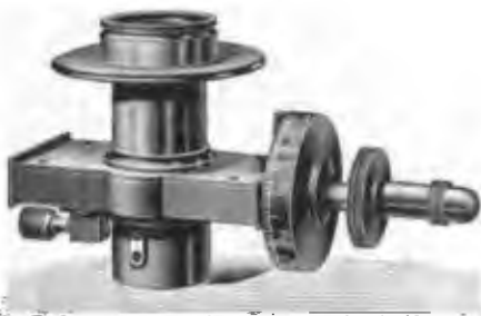
Fig. 209. Micromètre oculaire à fil mobile, modèle de la SOCIÉTÉ GENEVOISE POUR LA CONSTRUCTION DES INSTRUMENTS DE PHYSIQUE.
