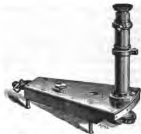
Fig. 238. Compas d'épaisseur. Modèle de la SOCIÉTÉ GENEVOISE POUR LA CONSTRUCTION DES INSTRUMENTS DE PHYSIQUE à Genève.
