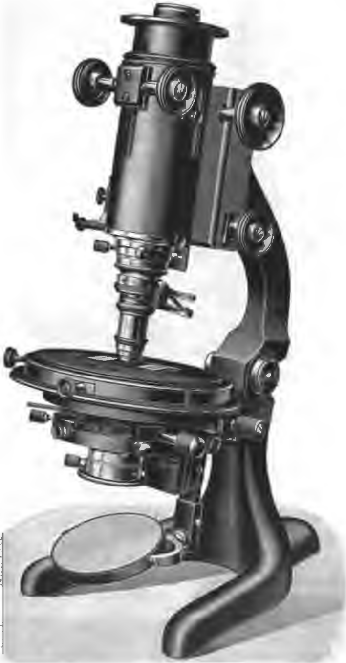
Fig. 205. Microscope polarisant du type n° 1 pour recherches pétrographiques, construit par la maison Leitz à Wetzlar.
