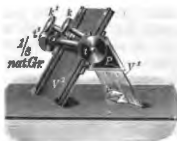
Fig. 491. Appareil de M. F. Stöber pour la taille des prismes. R. FUESS à Berlin.
