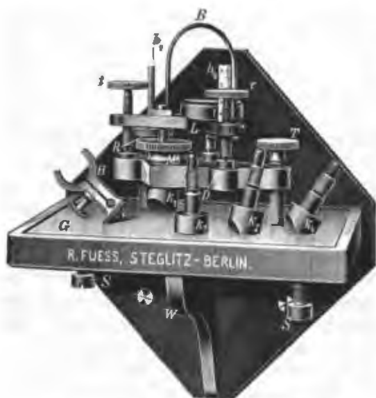
Fig. 489. Appareil de M. E. A. WÜLFING pour la préparation de sections orientées. Maison R. FUESS à Berlin.
