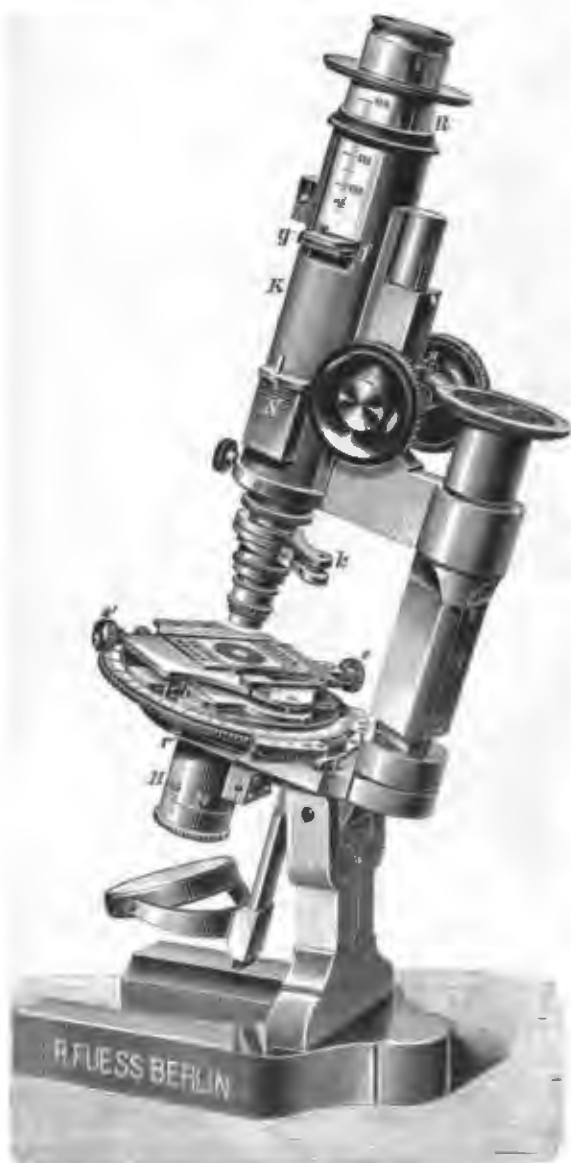
Fig. 204. Microscope polarisant du type n° 1 à centrage facultatif. Construit par la maison FUESS à Berlin.
