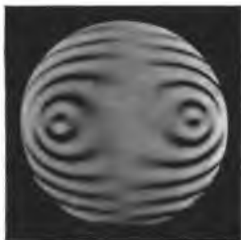
Fig. 400. Signe optique négatif. Le plan des axes optiques est orienté Est-Ouest; n_g du mica se trouve dans les quadrants N.O.—S.E.
