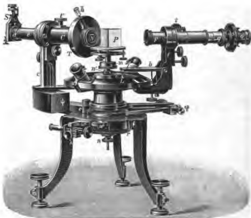
Fig. 465. Spectrophotomètre de GLAN, monté sur un goniomètre de la maison R. FUSS à Berlin.
