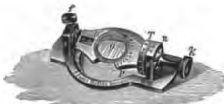
Fig. 272. Petite platine de M. DE FÉDOROW. R. FUSS à Berlin.
