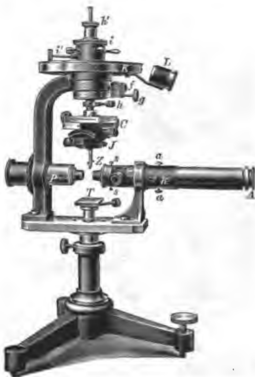
Fig. 413. Appareil de M. WÜLFING pour la mesure de l'angle des axes optiques. Modèle de la maison FUESS à Berlin.
