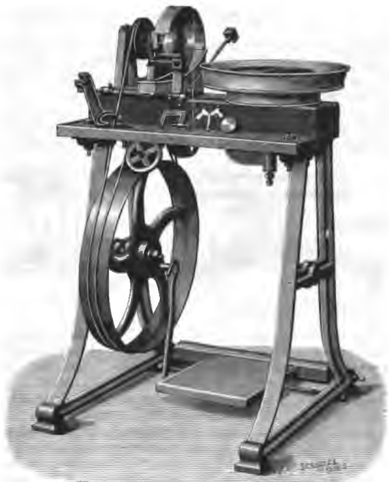
Fig. 486. Machine à préparer les coupes minces, construction de la maison R. FUSS à Berlin.
