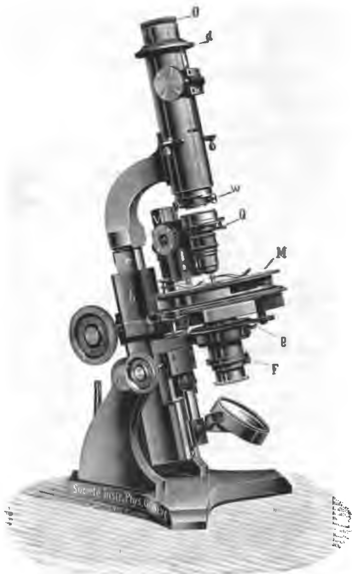
Fig. 201. Microscope polarisant du type n° 2 pour recherches pétrographiques, à centrage permanent, avec objectif tournant. Modèle de la SOCIÉTÉ GENEVOISE POUR LA CONSTRUCTION DES INSTRUMENTS DE PHYSIQUE à Genève.
