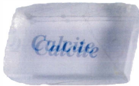
Илл.2. Кристалл кальцита, помещённый на текст, хорошо передаёт явление двойного преломления. Луч, входящий в одноосный минерал, диафрагируется на два луча, колеблющиеся с разной скоростью. Медленный и быстрый лучи переносят изображение по разным направлениям. Фото S. T. Schmidt.
