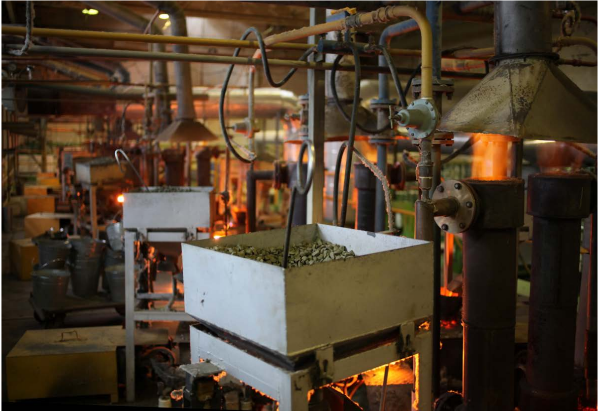
Визит на завод Нижней Туры. Производство изолирующих материалов (типа стекловаты) на основе базальта. Фото ©2014 Pierre Perroud.
